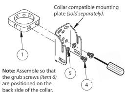
2. SLIDE COLLAR ONTO A Ø50MM POLE
